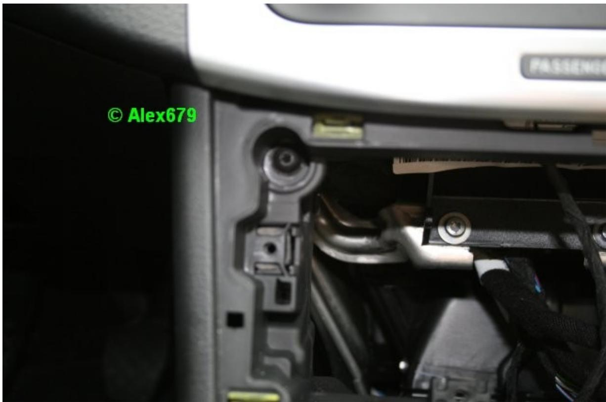
Die Mittelkonsole hinten leicht anheben und zurück ziehen. Dadurch löst sie sich vorn vom AT-Brett.
