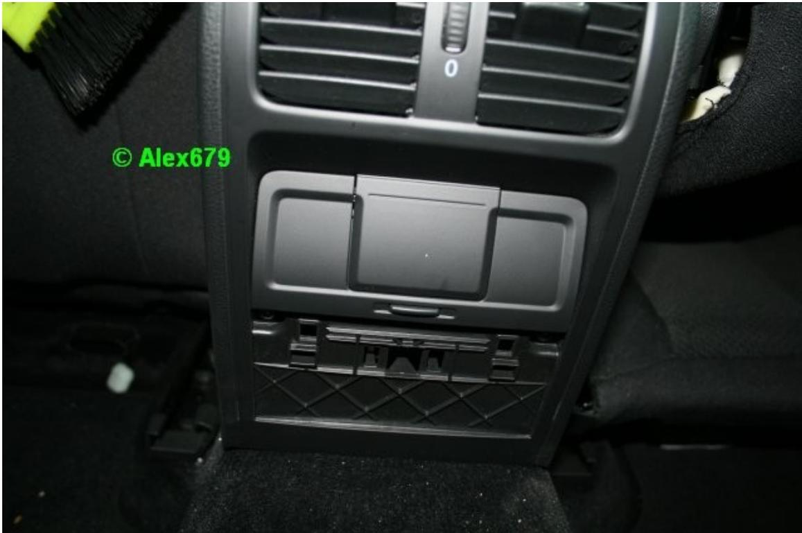
Dahinter befinden sich 2 Torx T20-Schrauben, diese heraus drehen
