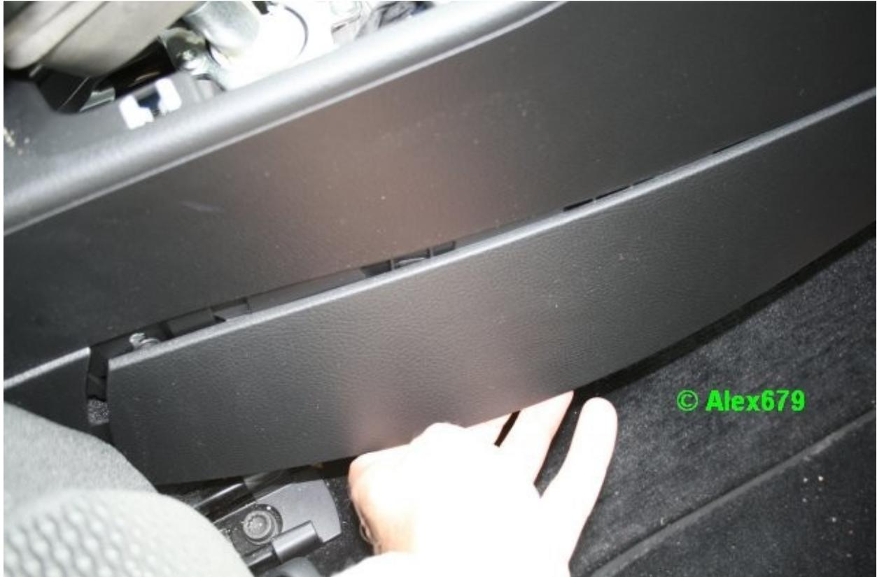
Dann das Verkleidungsteil in Richtung Heck ziehen, um aus der vorderen (bei der Schraube) Verrastung zu lösen. Auf der (FS) muss dieser Schritt auch ausgeführt werden.
