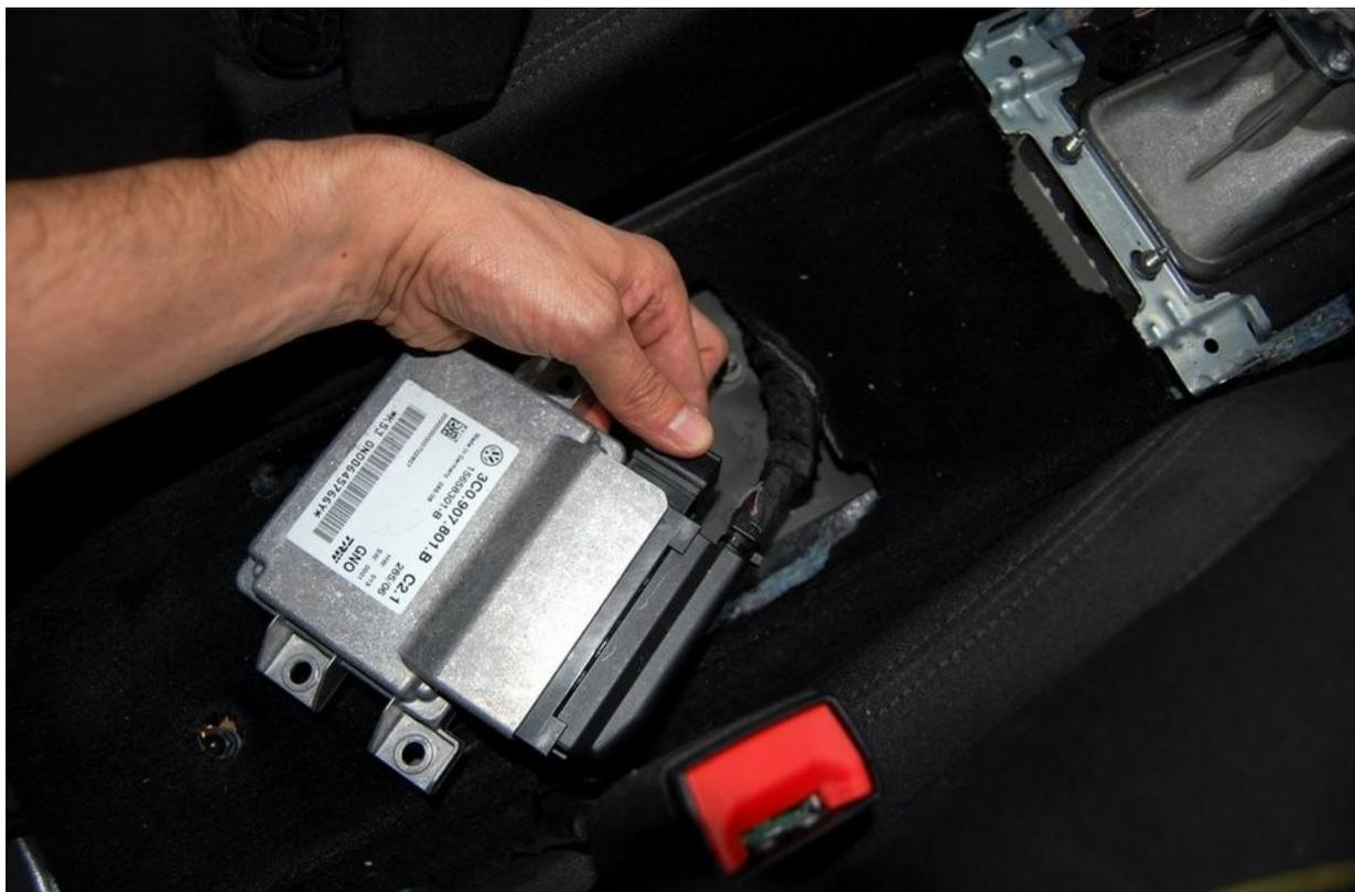
Den Kabelbinder entfernen und die Abdeckung abheben. Jetzt die lila Kontaktverriegelung komplett herausziehen.
