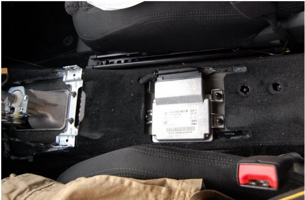
Am Besten ist es wenn man die drei Schrauben entfernt. So bekommt man den Stecker der Feststellbremse leichter ab.
