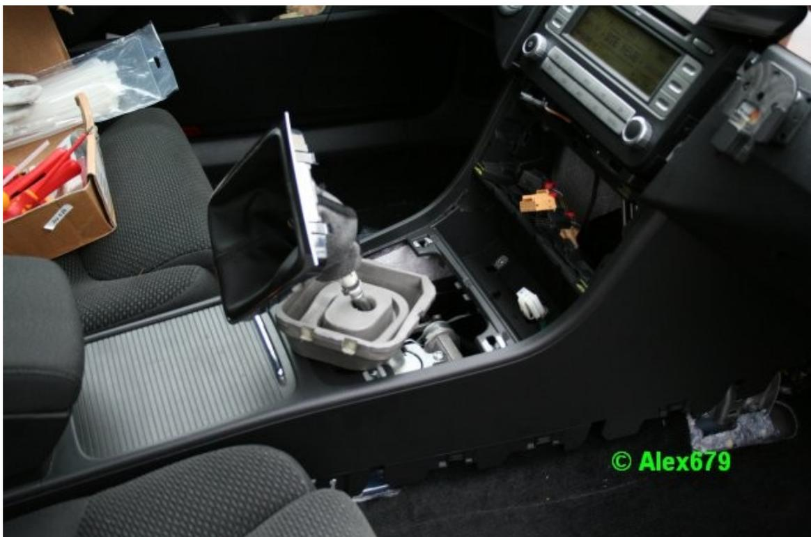
Hinter der Climatronic-Bedieneinheit befinden sich noch 2 Torx-Schrauben. Diese heraus drehen. Auf dem Bild ist nur 1 zu sehen, die andere befindet sich rechts.
