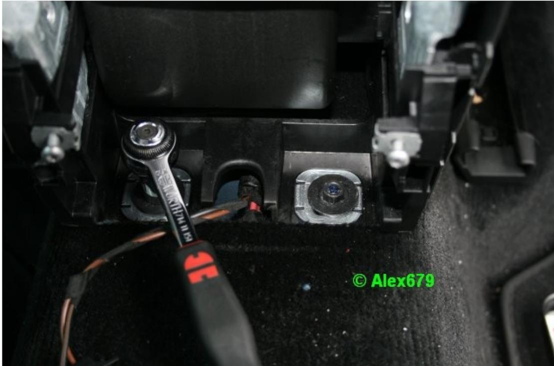
*(Der nächsten Schritte entfallen ab Modelljahr 2008, da es diese Abdeckungen und Schrauben nicht mehr gibt!) Den Sitz nach vorn fahren und diese Abdeckung entfernen.*
