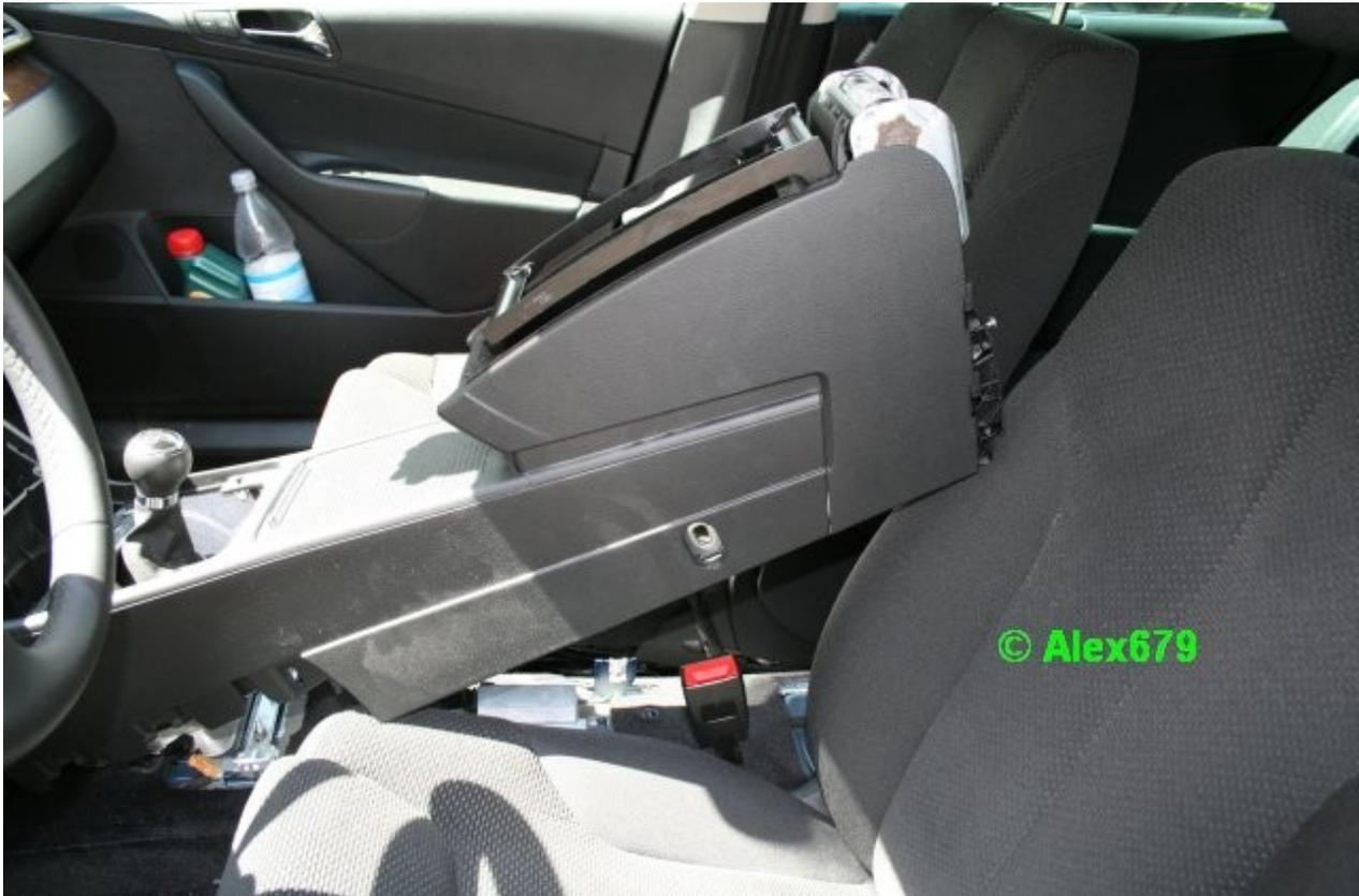
Nun sieht man auch schon hinter dem Schalthebel das Steuergerät der Feststellbremse.
