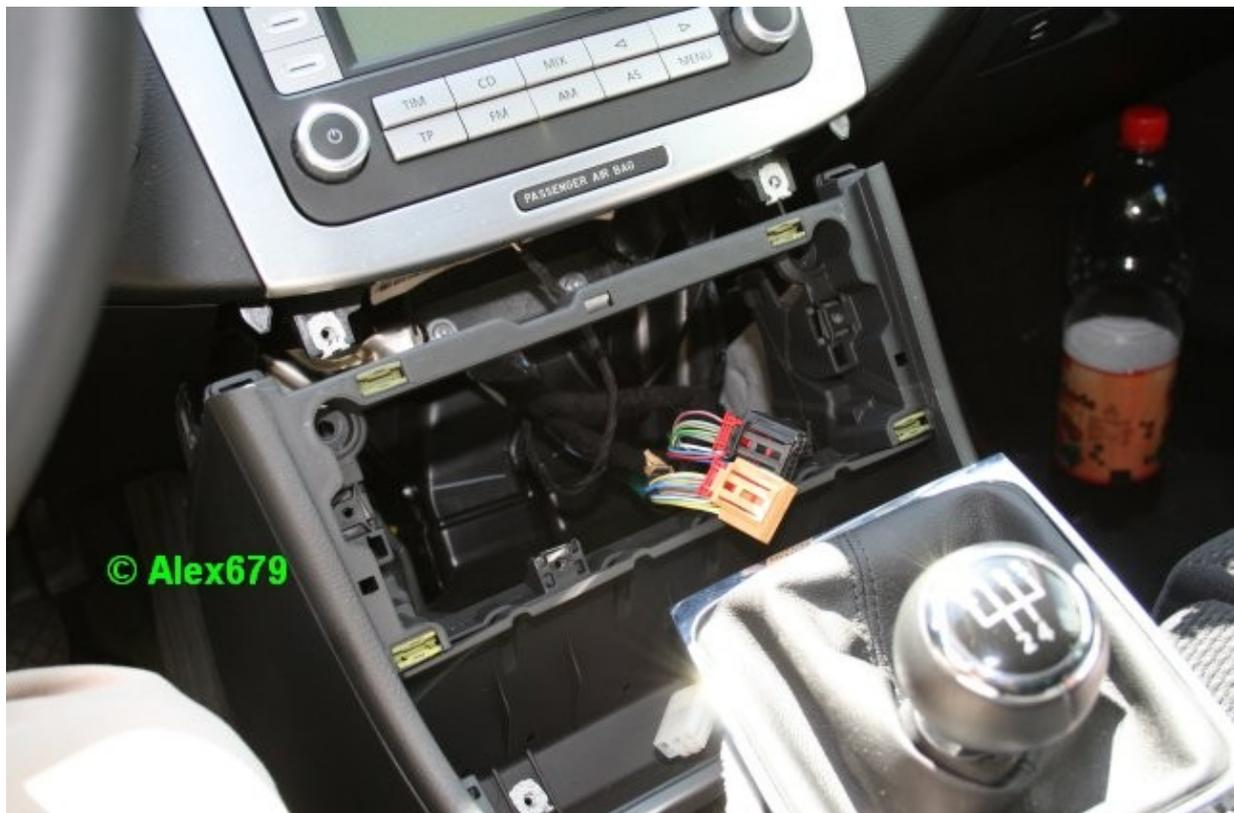
Dann die Mittelkonsole vorsichtig heraus heben/kippen. (Muss über den Schalthebel gefädelt werden)
