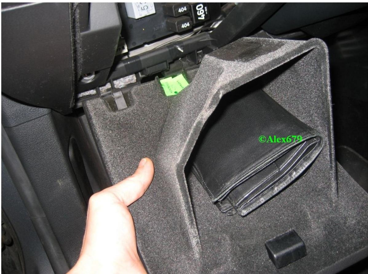
Die beiden Torxschrauben lösen, um den Sicherungskasten raus nehmen zu können.
