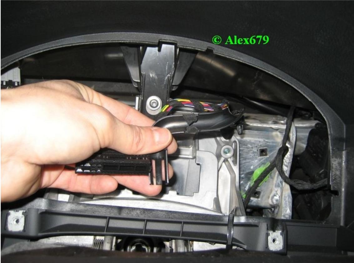
Nach der Vergleichsliste (s.u.) die PINs aus dem alten Stecker in den neuen umpinnen. Bis auf vier passen alle, bei den vier die alten PINs ab schneiden und die neuen anlöten.
